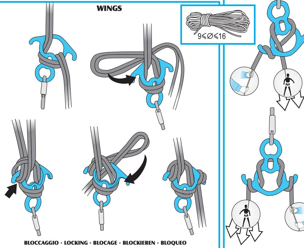
BLOCCAGGIO - LOCKING - BLOCAGE - BLOCKIEREN - BLOQUEO
